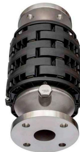
*MagnaClean DRX* introduit un nouveau design compact, étudié spécifiquement pour protéger les systèmes de chauffage, basé sur des technologies et composants de filtration magnétique à usage industriel. Le filtre se compose d'une ceinture magnétique innovante comprenant 48 à 80 aimants néodyme, autour de la cartouche centrale en acier inoxydable, pour une capture optimale des boues et un volume de rétention exceptionnel dans un encombrement très réduit.
