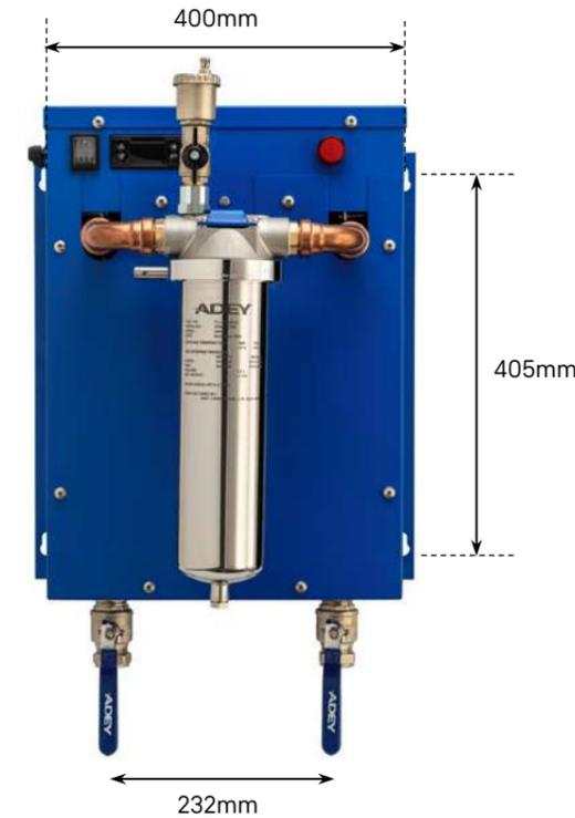
L'unité MagnaClean CMX Nano Pumped Sidestream doit être installée sur un mur solide, un cadre-support mécanosoudé ou une structure suffisamment solide pour supporter le poids de l'unité pleine d'environ 23 kg, en utilisant les dimensions de montage figurant ci-dessous. Veiller à respecter le dégagement minimal requis indiqué ci-dessous pour pouvoir effectuer l'entretien de l'unité.
