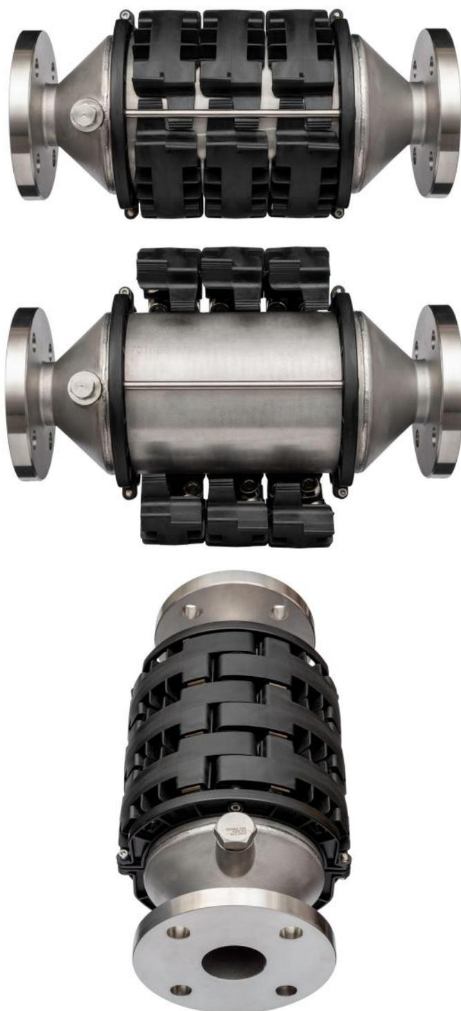
*MagnaClean DRX* introduit un nouveau design compact, étudié spécifiquement pour protéger les systèmes de chauffage, basé sur des technologies et composants de filtration magnétique à usage industriel. Le filtre se compose d'une ceinture magnétique innovante comprenant des ceintures de 48 à 80 aimants néodyme, autour de la cartouche centrale en acier inoxydable, pour une capture optimale des boues et un volume de rétention exceptionnel dans un encombrement très réduit.
