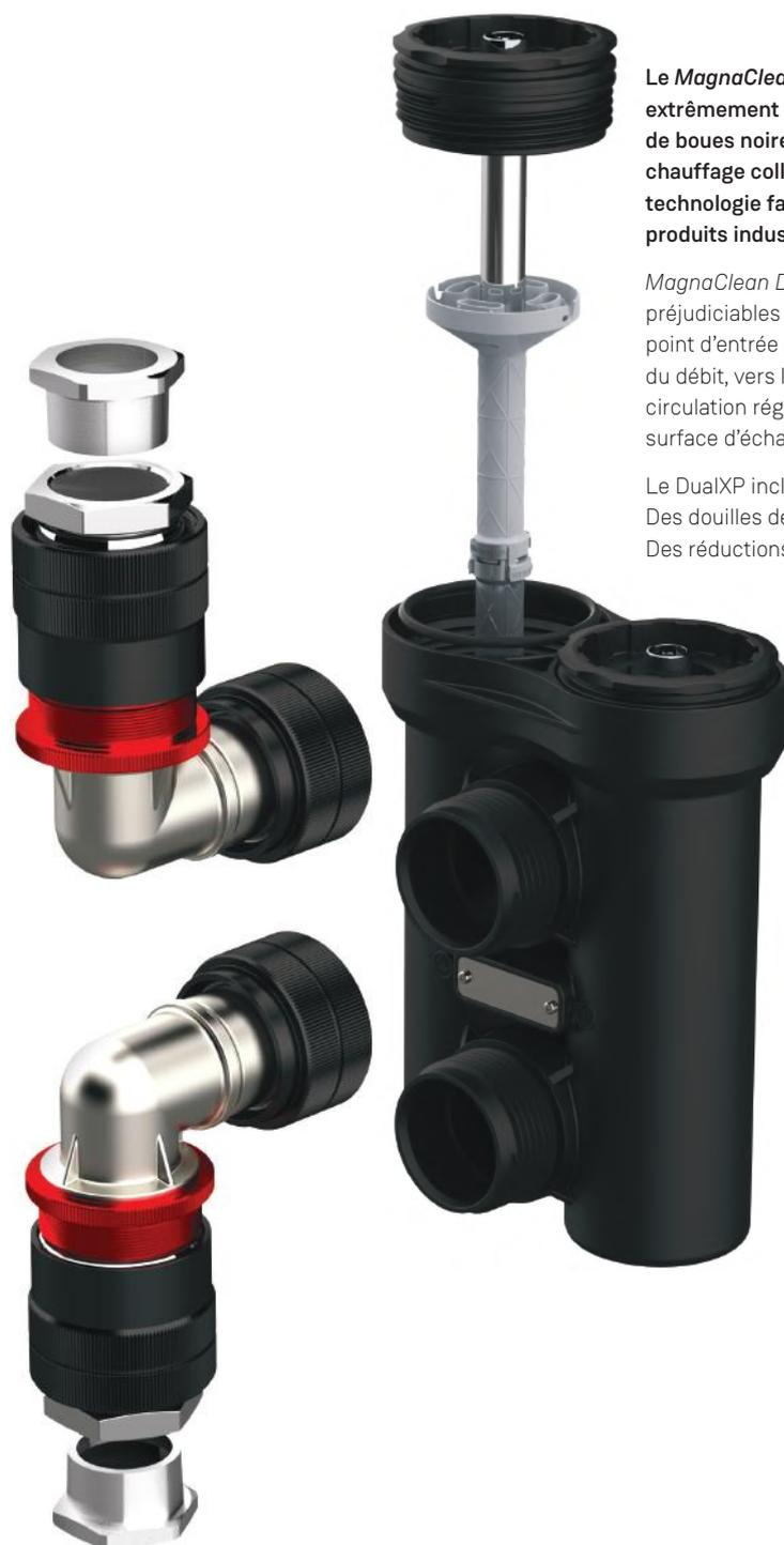
Le *MagnaClean DualXP* possède deux zones de capture magnétique extrêmement puissantes, qui lui permettent d'éliminer un grand volume de boues noires. Cela en fait la solution idéale pour les installations de chauffage collectif de petite et moyenne puissance. Ce filtre de haute technologie fait le lien entre la gamme des filtres domestiques et des produits industriels de *MagnaClean*.
