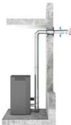
Dans ce cas, la prise d'air est réalisée soit dans la pièce où le poêle est installé, soit à l'extérieur (prise d'air murale avec grille). Le débouché du conduit est réalisé en ZONE 1
